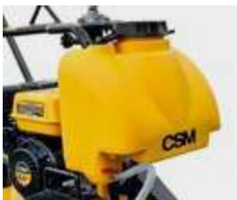
TANQUE DE ÁGUA
