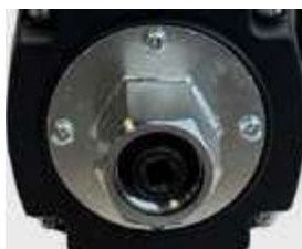
LOCAL PARA ACOPLAMENTO DA MANGUEIRA
